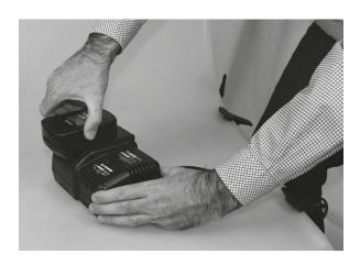
Paso 2: / Step 2: Empujar la batería sobre el carril hasta el final del carril. Push the battery, through the rail until the end of it.
